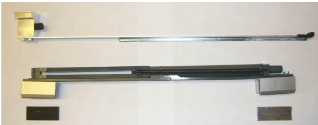
Die Teile der Einzugsdämpfung. Oben Stopper Unten Dämpfungssystem
